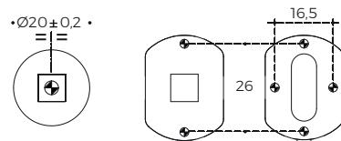
**Dimensioni fresatura foro yale posizione viti di fissaggio**
